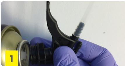
1 Enroskar la boquilla aplicadora en la parte superior del envase. Agitar varias veces para que los gases en su interior puedan mezclarse bien.
